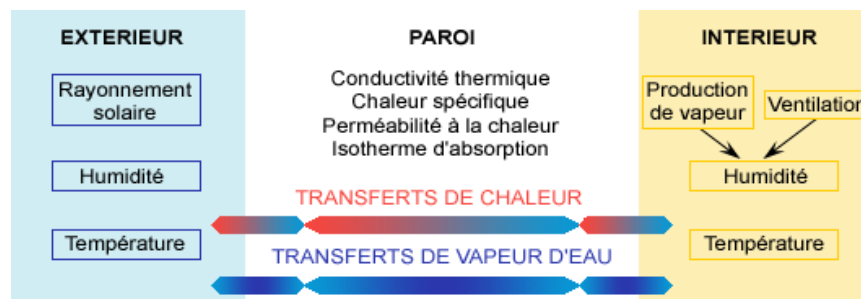
Figure 2 : Comportement hygrothermique d'un mur respirant.
